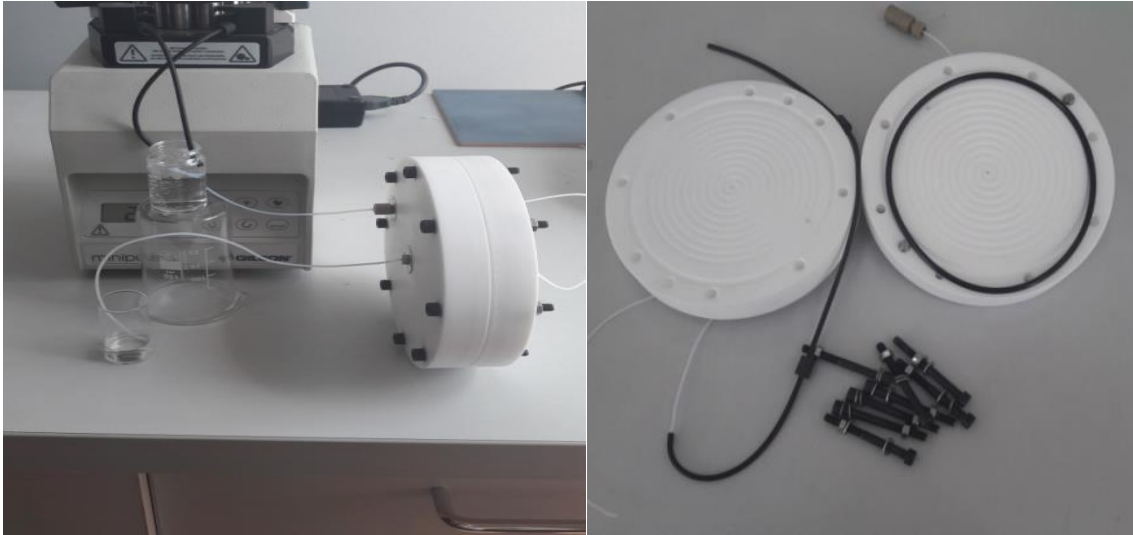
Sistemul SLM de extracție și concentrare a pirazinelor
